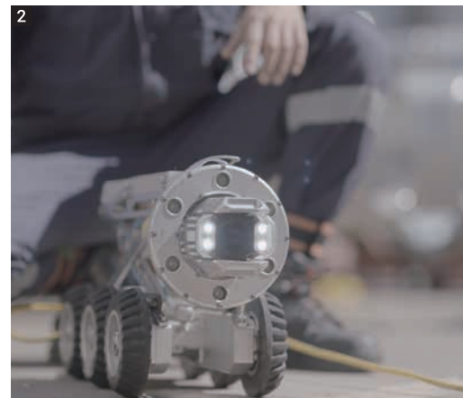
1_ 360도 회전하며 배관내부를 촬영하는 로봇카메라 2_ 테스트 중인 로봇 검사
