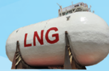
LNG Fuel Tank
